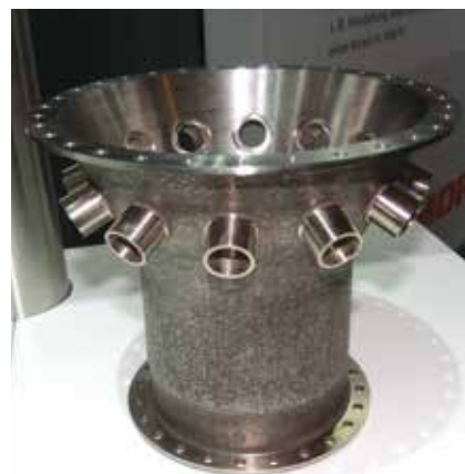
Корпус турбины, созданный по комбинированной технологии, нержавеющая сталь. Фото со стенда компании DMG/MoriSeiki, выставка EuroMold 2013.
