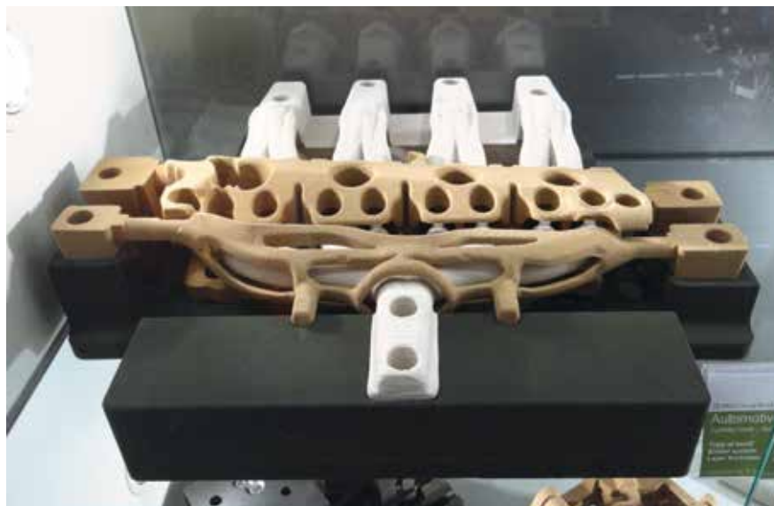
Песчаная литейная форма головки блока цилиндров ДВС, со стержнями, построенная по технологии InkJet. Фото со стенда компании ExOne, выставка EuroMold 2013
