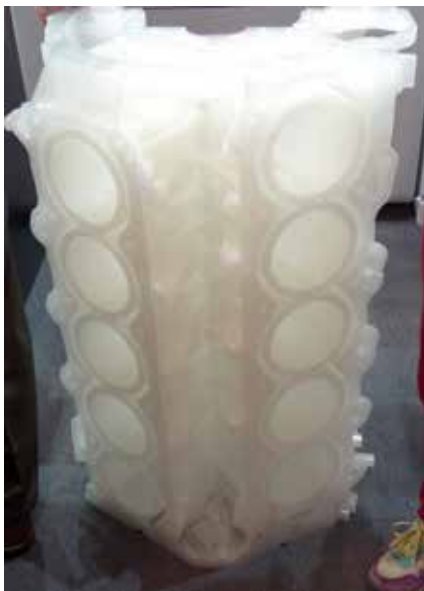
Литейная выжигаемая модель блока цилиндров двигателя V10, построенная по технологии SLA в режиме QuickCast. Фото со стенда компании 3D Systems, выставка EuroMold 2013
