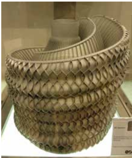
Масляный сепаратор, построенный по технологии SLM из Al сплава. Фото со стенда компании EOS, выставка EuroMold 2013
