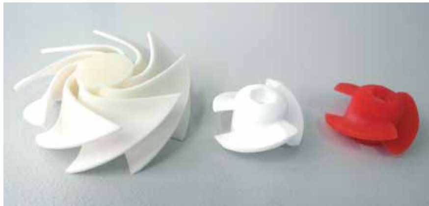
Полимерные SLS-модели: функциональная полиамидная модель, полистирольная модель и инфильтрованная воском литейная модель
