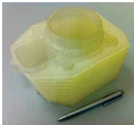
Литейная SLA-модель и Al-отливка
