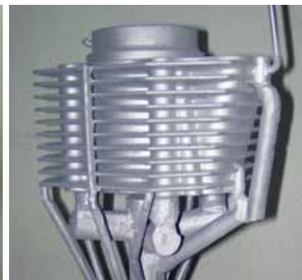
Литейная SLA-модель и Al-отливка
