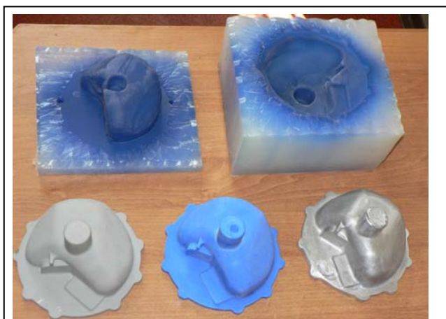
Силиконовая форма (вверху), мастер-модель (внизу слева), восковая модель (в середине), металлическая отливка (справа)
