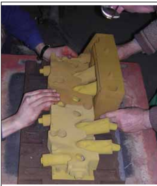
Рис. 13 Сборка формы и подготовка к заливке металла
