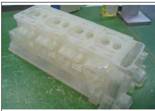
Рис. 1 Стереолитографическая модель головки цилиндров
