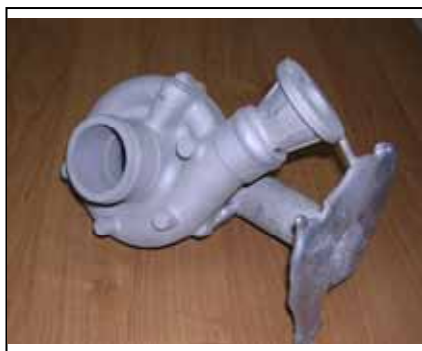
Рис. 6 Отливка корпуса компрессора (турбокомпрессора) после удаления формовочной смеси
