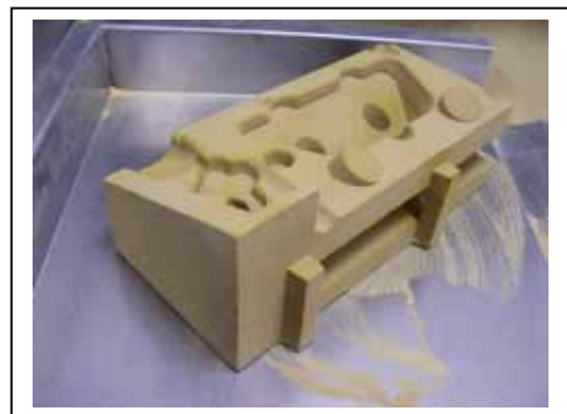
Рис. 12 Процесс спекания песка, получение фрагментов формы
