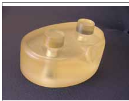
Рис. 9. Стереолитографическая модель холодильника и его отливка.
