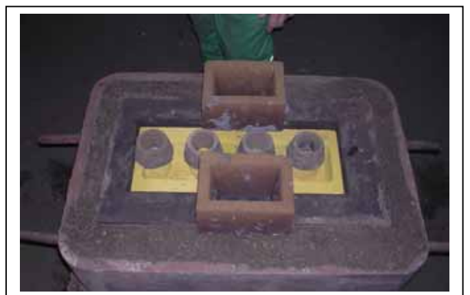
Рис. 13 Сборка формы и подготовка к заливке металла
