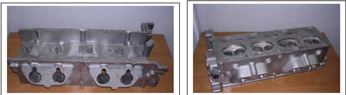
Рис. 14 Отливка после удаления литниковой системы, термообработки и проверки на герметичность.
