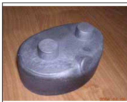
Рис. 9. Стереолитографическая модель холодильника и его отливка.
