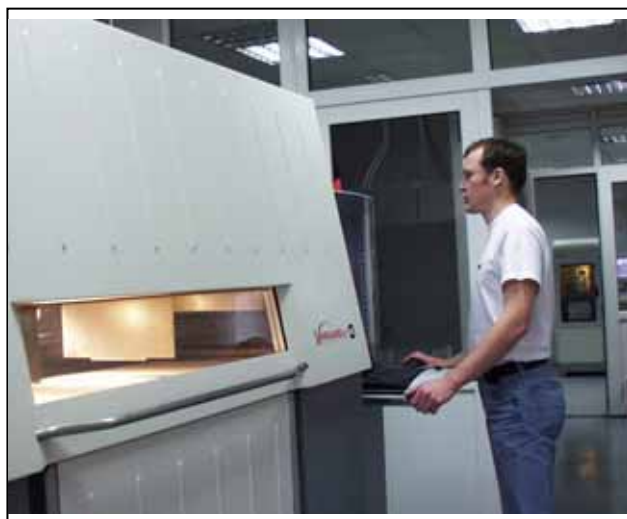
Рис. 3 SLS -машина Vanguard фирмы 3D Systems
