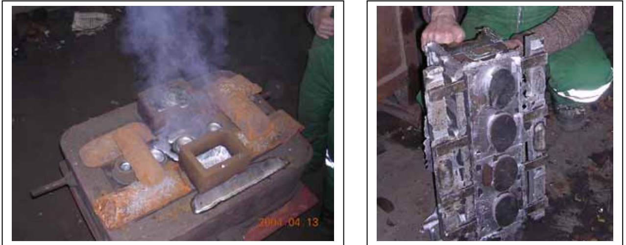
Рис. 9.13 Остывание формы и извлечение отливки
