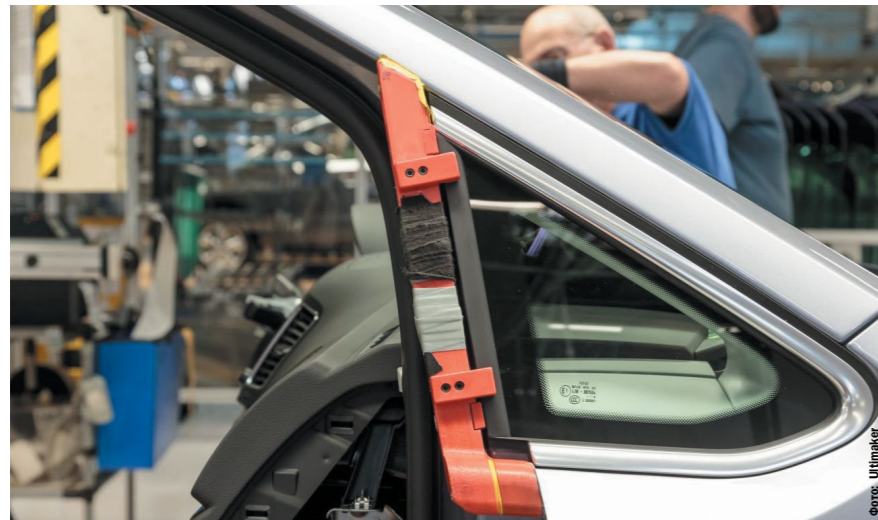
Аддитивная технология позволяет снизить стоимость оснастки для сборки VW Sharan со 180 до 35 евро, а сроки изготовления с 8 до 6 дней
