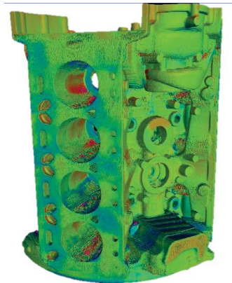
Современные данные компьютерной томографии. Блок цилиндров ДВС V8.
