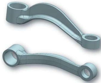
Рычаг подвески автомобиля, алюминиевый сплав. Снижение массы 12%. Масса до оптимизации: 854 г, масса после оптимизации: 749 г
